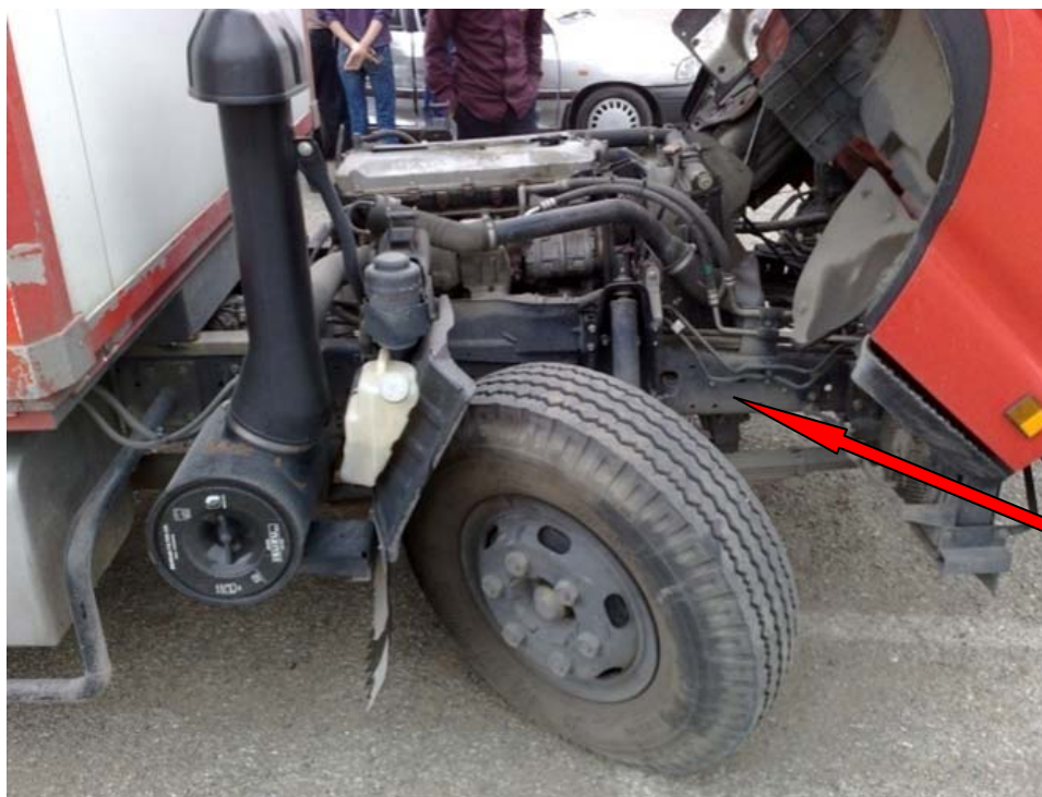
۱۴- روی تیغه شاسی داخل محفظه موتور : روی تیغه شاسی چپ و راست داخل محفظه موتور معمولاً شماره شاسی اتوبوس ها حک میشود.
